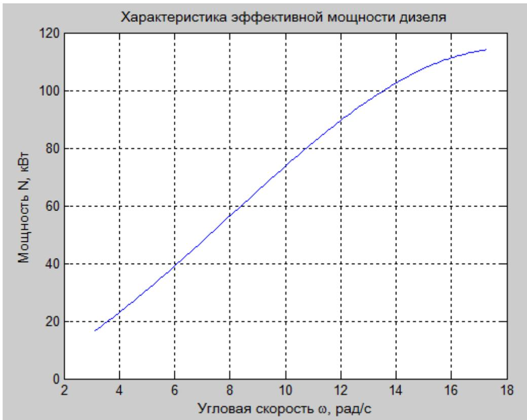
Рис. 12. Результат расчета характеристики эффективной мощности дизеля
