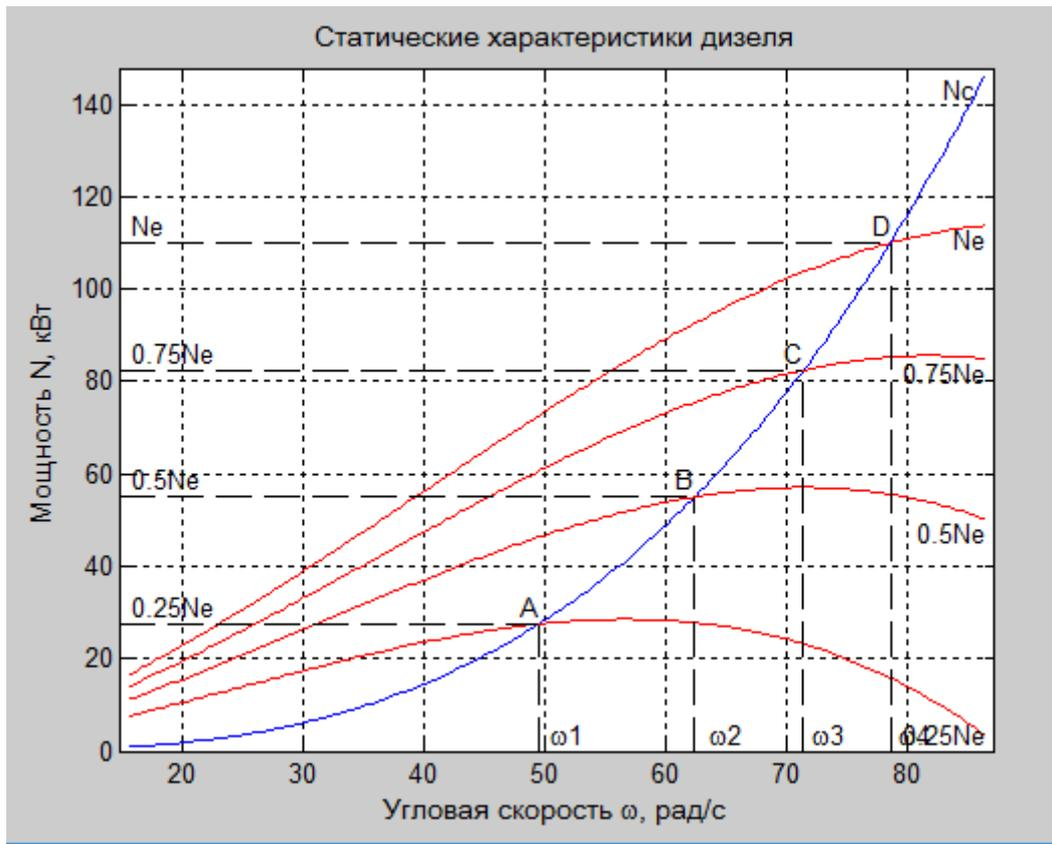
Рис. 14. Результат расчета характеристик частичной эффективной мощности
